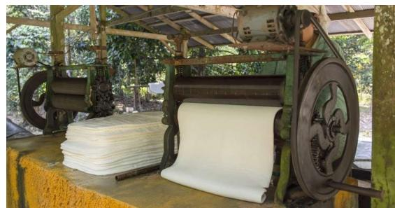
Proses ini bermula dengan penapisan susu getah bagi membuang kotoran dan bahan asing, diikuti dengan penggumpalan menggunakan asid asetik atau formik untuk membentuk gumpalan pejal. Getah yang telah menggumpal kemudian dikeringkan untuk menghasilkan pelbagai bentuk seperti lateks pekat, getah keping atau getah berketul, bergantung pada keperluan industri (LGM, 2021).
